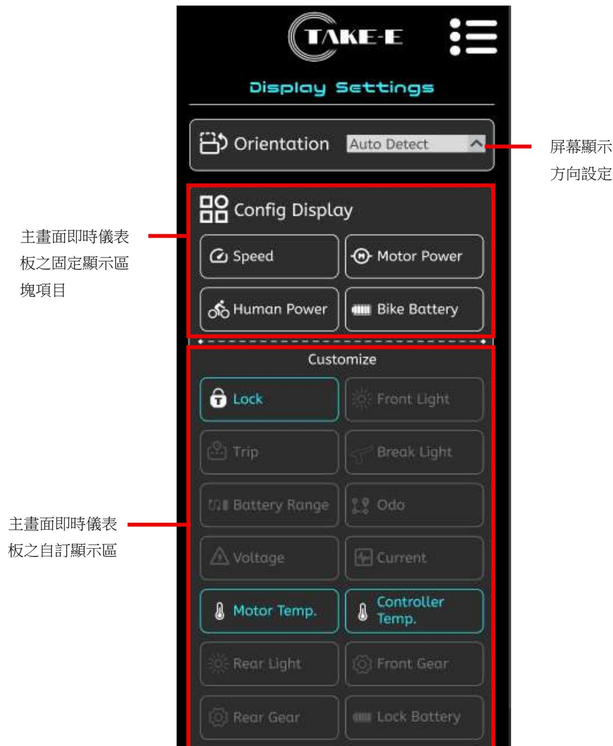
• Orientation 為顯示屏幕方向調整功能，分為 Auto Detect（自動偵測）、Manual Change（手動變更）、Always Portrait（固定直式）三種選項。
